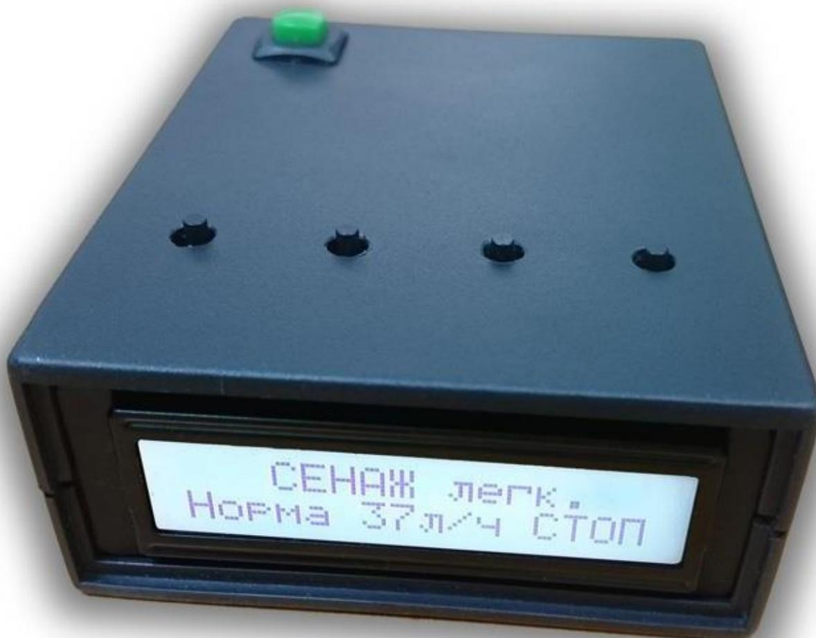
Контроллер позволяет управлять расходом жидкости при помощи выбора нужного профиля с заранее заданными настройками, либо в ручном режиме. В случае окончания рабочей жидкости, сигнализирует об этом звуковым сигналом. В случае сбоя электропитания, при последующем включении, восстанавливает состояние, в котором он находился на момент отключения питания.
