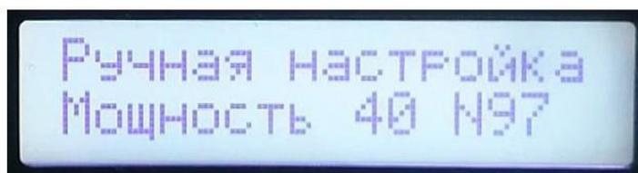
Режим ручного управления мощностью нужен для служебных целей. Для контроля показаний расходомера, которые отображаются в нижнем правом углу.
