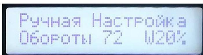
Режим ручного управления оборотами, нужен в том случае, если необходим расход жидкости, отличный от того который задан в предустановленных профилях.
