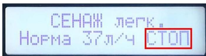
Запуск компрессора производится нажатием кнопки «старт-стоп» После этого в нижнем правом углу начнёт отображаться мощность, подаваемая на компрессор. Которая в процессе работы будет меняться, подстраивая расход жидкости, под параметры выбранного профиля.
