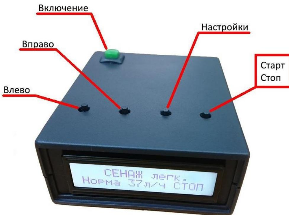
После включения, в верхней строке экрана будет отображаться название профиля, а в нижней строке подробности: расход жидкости и состояние компрессора.
